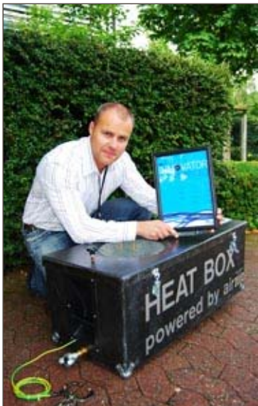
Jan Olav Hurlen med sin prisnominerte innovasjon. HeatBox-en varmes opp ved hjelp av trykkluft og kan brukes i eksplosjonsfare-soner både på offshoreinstallasjoner og landanlegg.
